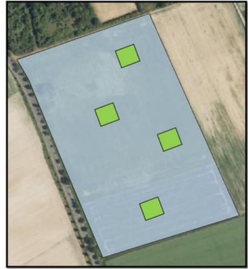
Abbildung 3: Beispielhafte Gestaltung zum Erhalt von Feldlerchenrevieren im PV-Park - Blau: Module mit besonntem Reihenabstand von 2,5 Meter zwischen Mitte April und Mitte September. Extensive Bewirtschaftung der Reihen. Grün: Vier unbebaute Bereiche von mind. 30x30 Meter („Lerchenfenster“)
