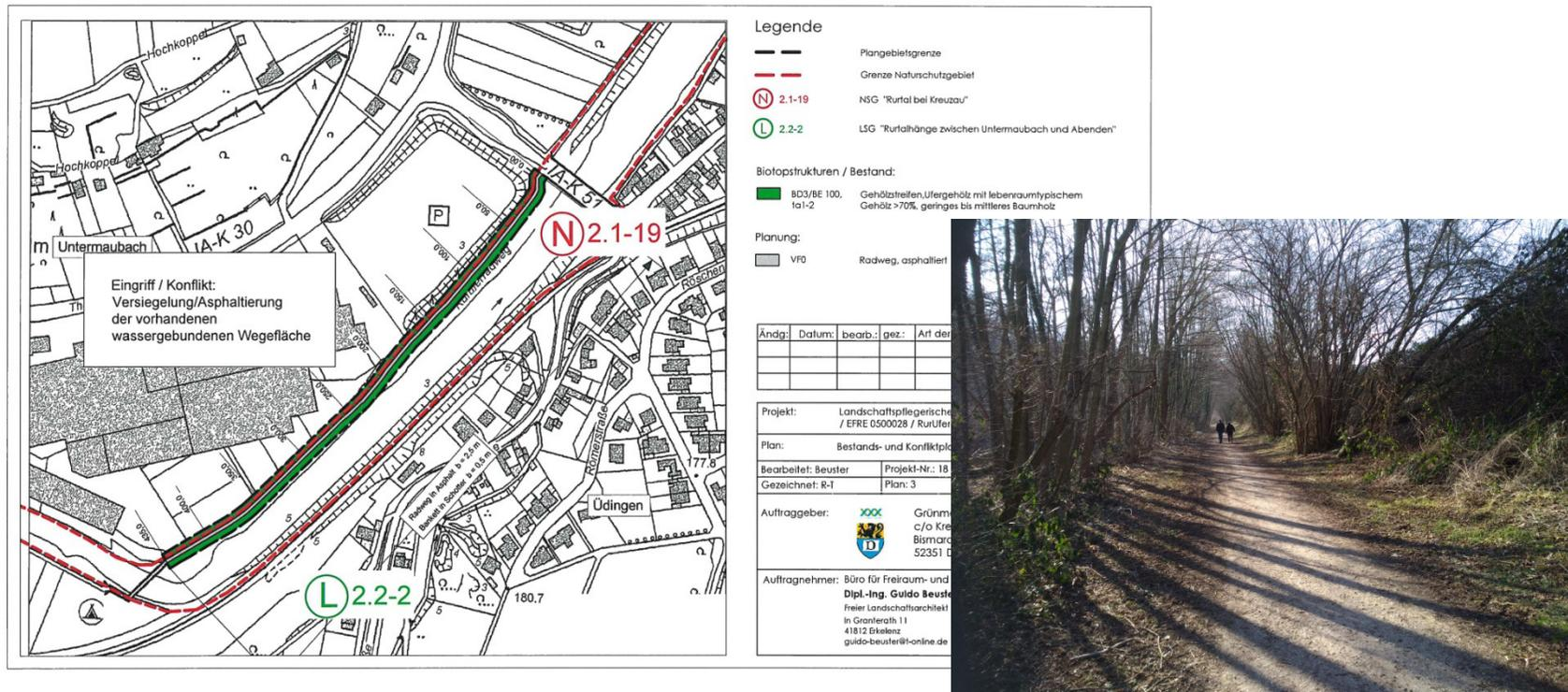
Eingriff: Asphaltierung vorhandener wassergebundener Wegefläche auf einer Länge von etwa 435 m und einer Breite von 2,50 m. Dies entspricht einer Fläche von etwa 1.087,50 m<sup>2</sup>.
