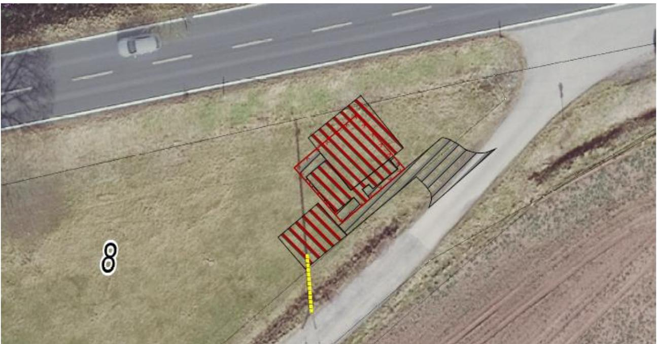
**Abbildung 2: Lageplan der Mobilfunkanlage: rot: Vollversiegelung, grau: Teilversiegelung; gelb: Stromanbindung**
