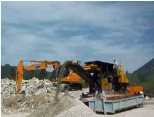
Brecheranlagen können aus Bauschutt Recyclingmaterial in unterschiedlichen Körnungen herstellen.
