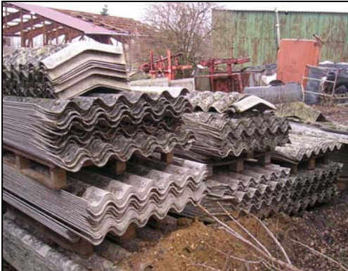
Asbesthaltige Eternitplatten dürfen nicht wiederverwendet werden.
