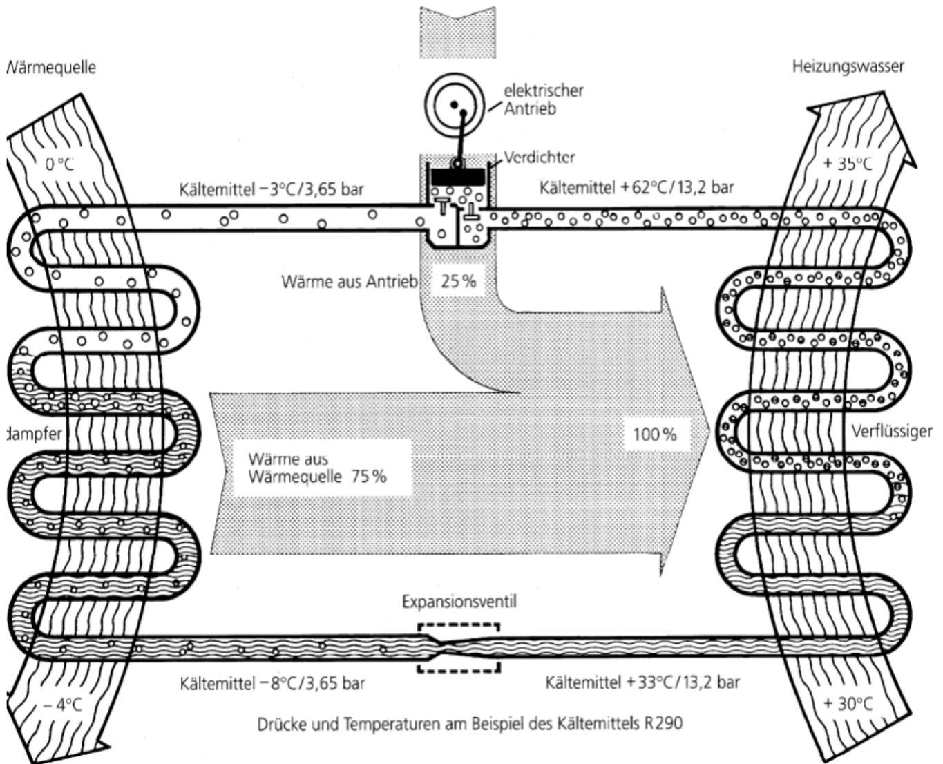
Schematische Darstellung der Funktionsweise einer Erdreich-Wärmepumpe. Das Wasserrecht befasst sich mit dem Kreislauf, der sich außerhalb des Gebäudes befindet.
